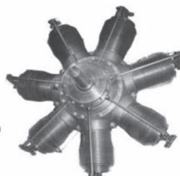
тип: Gnome Lambda снага: 80KS (59kW) маса: 87kg година: 1912
